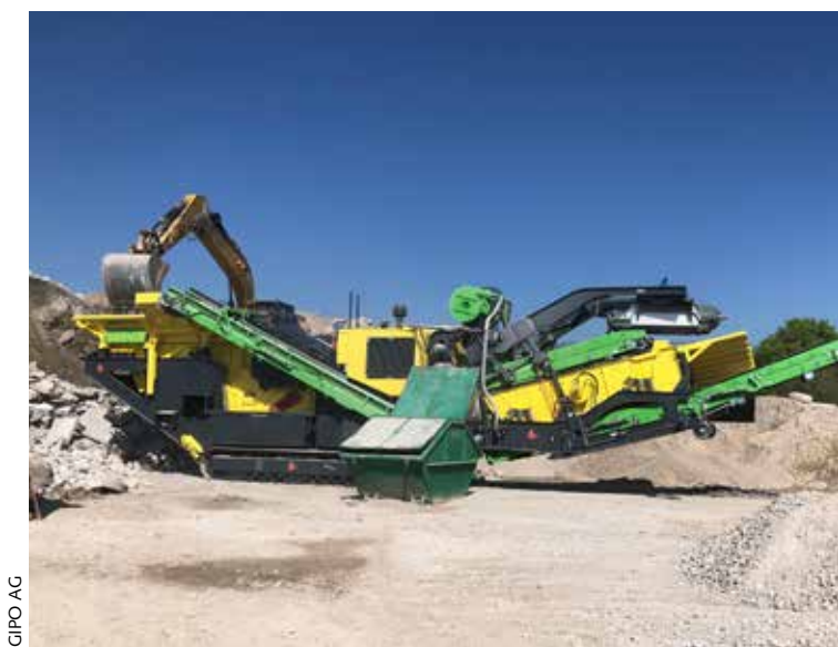
Raupenmobiler Backenbrecher mit Siebeeinheit Tracked jaw crusher with screening unit
