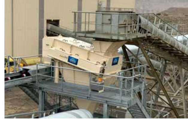
Fingerrollenrost zur Siebschutttaufbereitung Finger roller screen for processing screenings
